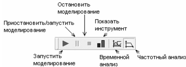
Чтобы запустить моделирование. Если на схеме присутствует символ «**Осциллограф**» или «**Плоттера Боде**», то в процессе моделирования откроется окно соответствующего прибора.
