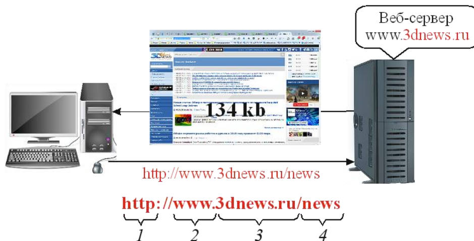
Рис. 9.10 – Гипертекстовая технология Веб: указание на протокол передачи гипертекста HTTP (Hyper Text Transfer Protokol) (1); тип сервера (2); доменное имя 2-го уровня сервера (3); имя запрашиваемой страницы веб-сервера (4)
