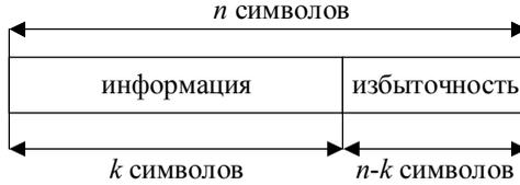
Рисунок 4.5 – Добавление избыточности в блочный код  $(n, k)$
