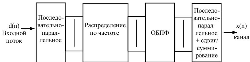
Рисунок 2.1 – Реализация банка фильтров с помощью ОБПФ
