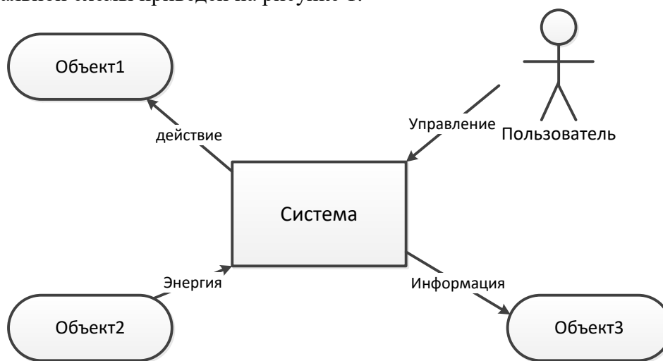
Рисунок 1 – Классический тип функциональной схемы
