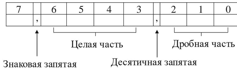
Рис. 1.8 – Разрядная сетка цифрового устройства с целой и дробной частью
