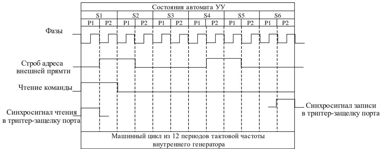
Рис. 10.9 – Машинный цикл УУ
