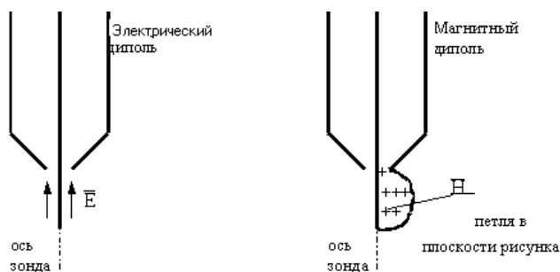
Рисунок 3.2 – Устройство электрического и магнитного зондов
