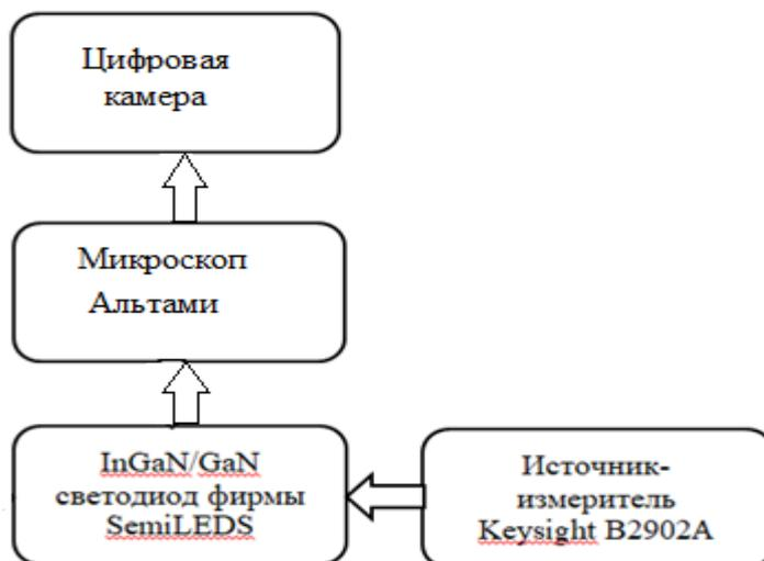
Рисунок 3.2 – Структурная схема экспериментальной установки
