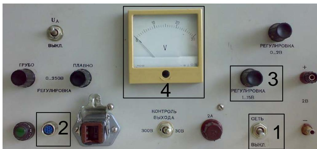
1 – выключатель сети; 2 – разъем для подключения лабораторных макетов;
