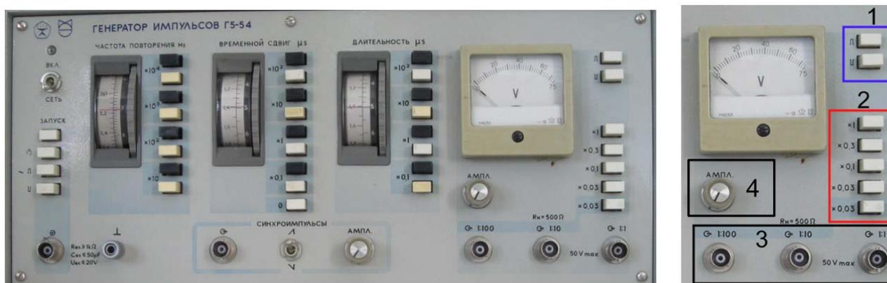
Рисунок 1.4 – Лицевая панель генератора прямоугольных импульсов Г5-54
