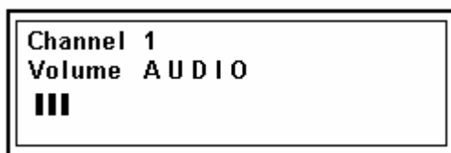
Рисунок Г.3 – Сообщения о режиме регулировки уровня сигнала для первого аудиоканала
