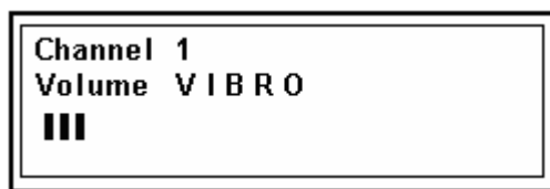
Рисунок Г.4 – Сообщения о режиме регулировки уровня сигнала для первого виброканала
