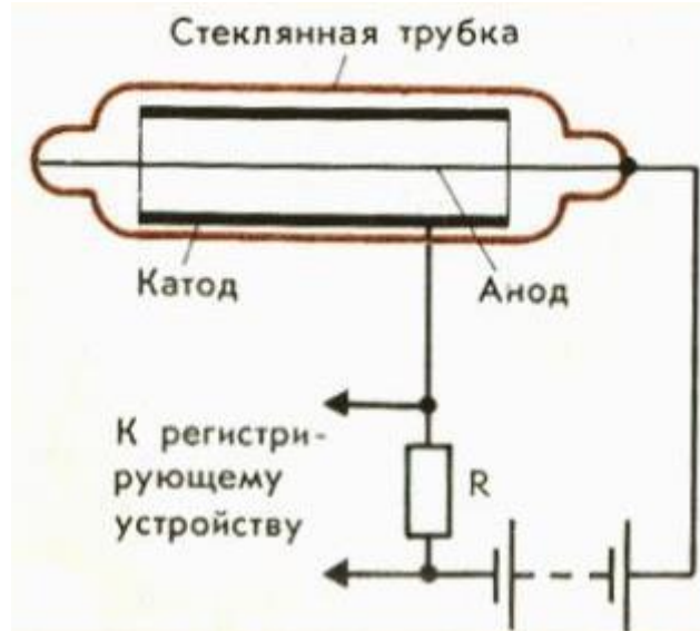
Рисунок 2.1 – Схема подключения счетчика Гейгера-Мюллера
