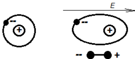
Рисунок 1.2 – Схема, поясняющая возникновение электронно-упругой поляризации
