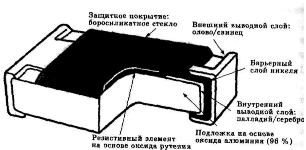
Рисунок 3.10. Типовая конструкция прямоугольного толстопленочного чип-резистора.
