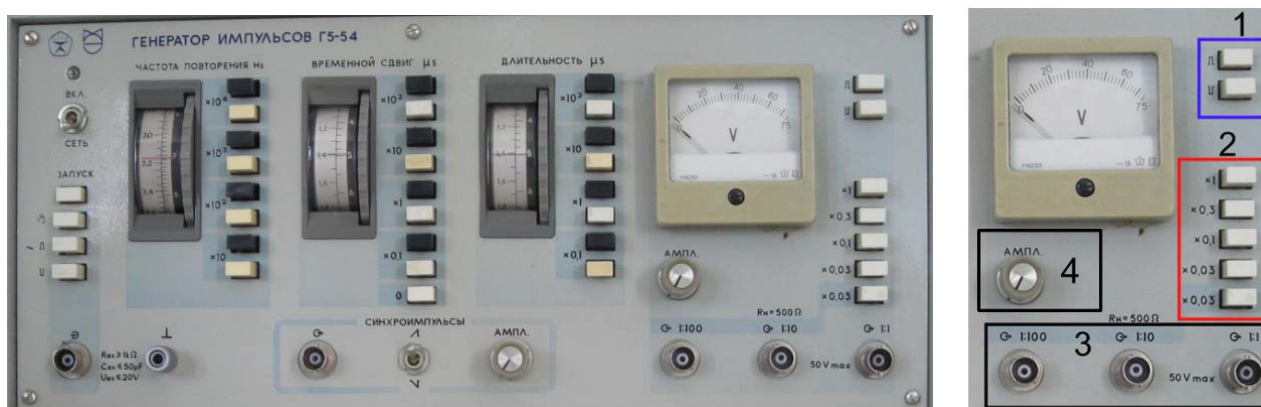
Рисунок 1.4 – Лицевая панель генератора прямоугольных импульсов Г5-54
