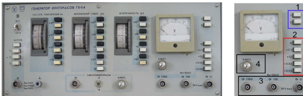
Рисунок 1.4 – Лицевая панель генератора прямоугольных импульсов Г5-54
