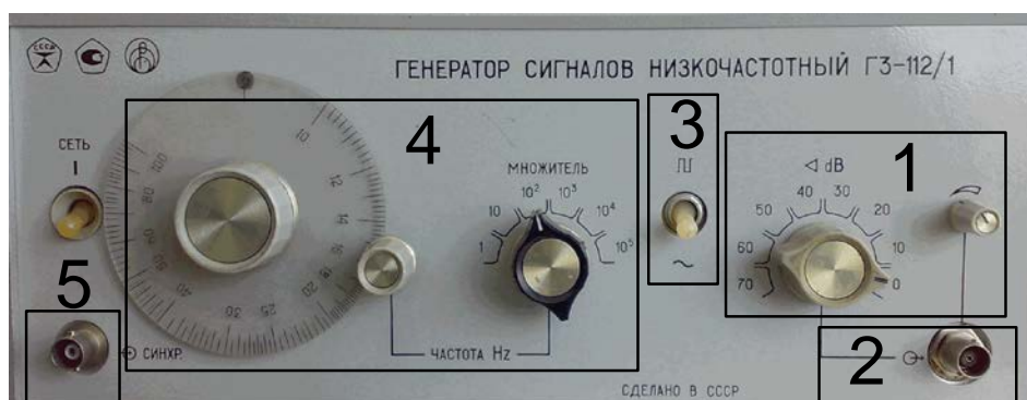
Рисунок 1.3 – Лицевая панель генератора сигналов низкочастотного ГЗ-112/1
