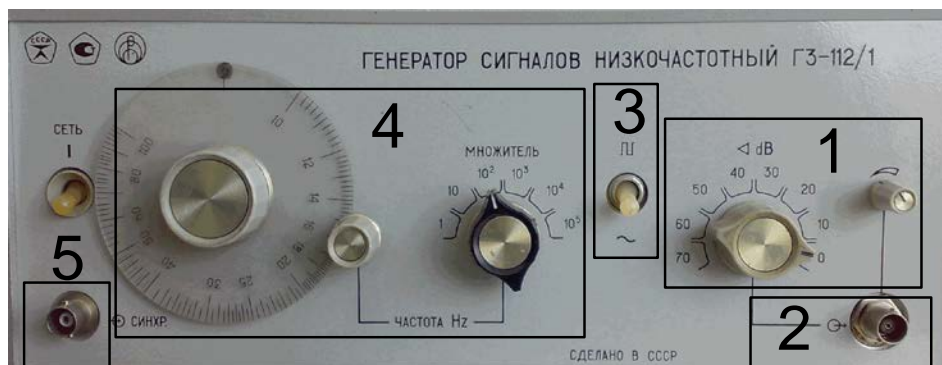
Рисунок 1.3 – Лицевая панель генератора сигналов низкочастотного ГЗ-112/1
