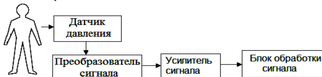
Рисунок 2.2 – Обобщенная структурная схема сфигмографического ИП
