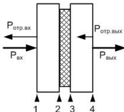
Рис. 1.2. Схема пленочного поляроида.
