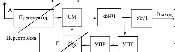
Приёмник с прямым преобразованием частоты асинхронного типа
