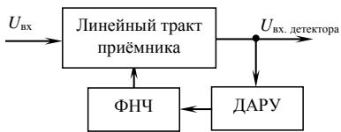
Автоматическая регулировка усиления «вперёд»
