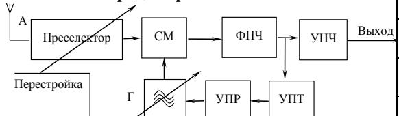
Приёмник с прямым преобразованием частоты асинхронного типа
