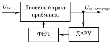
Автоматическая регулировка усиления «вперёд»
