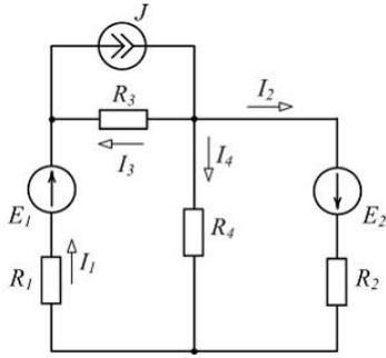
$$-E_1 I_1 - E_2 I_2 + J U_3 = R_1 I_1^2 + R_2 I_2^2 + R_3 I_3^2 + R_4 I_4^2$$
