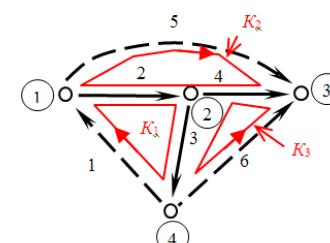
На рисунке показана электрическая схема цепи и ее направленный граф, на котором выделены главные сечения и контура. Записать матрицу главных сечений схемы.
