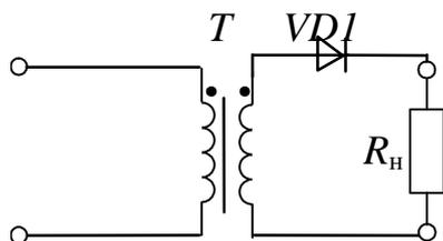
1. Однофазная однополупериодная
