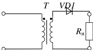
1. Однофазная однополупериодная
