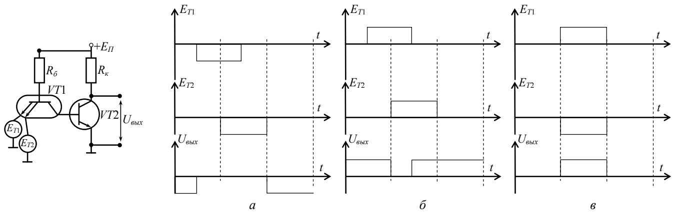
28. Выбрать временные диаграммы на входе и выходе (схема логического отрицания на КМДП-структуре)
