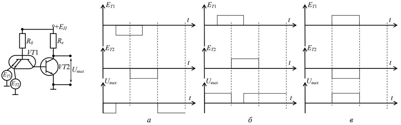
8. Выбрать временные диаграммы на входе и выходе (схема логического отрицания на КМДП-структуре)
