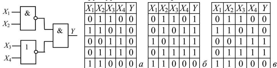
27. Выбрать временные диаграммы на входах и выходе (схема малосигнального базового элемента ТТЛ «И-НЕ»):
