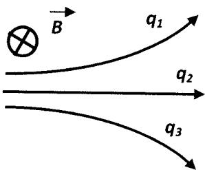
4. Микрочастицы влетают в однородное магнитное поле с постоянной скоростью, как показано на рисунке. Какой заряд имеют частицы?
