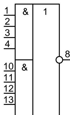
8. Указать уровни сигналов, которые необходимо подать на входы  $X_1$ ,  $X_2$  и  $X_3$  при снятии передаточной характеристики для входа  $X_4$ .
