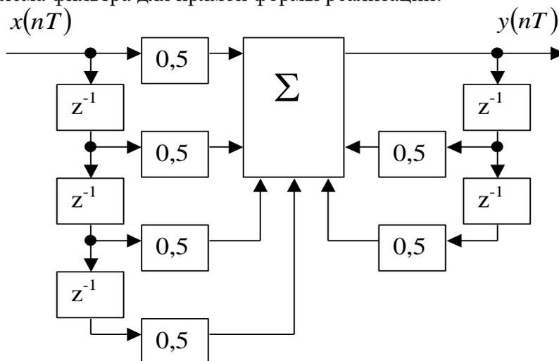
Сколько элементов задержки будет в структурной схеме данного фильтра для канонической формы реализации?
