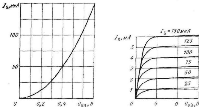
18. Проподная характеристика транзистора  $I_k = bU_{БЭ}^2$  ( $b = 100$  мА/В<sup>2</sup>). Амплитуда напряжения гетеродина  $U_{г} = 100$  мВ. Определите максимально возможную крутизну преобразования по первой гармонике колебания гетеродина.
