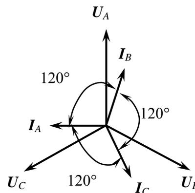
8. На векторной диаграмме показаны векторы фазных токов ( $I_A, I_B, I_C$ ) и напряжений ( $U_A, U_B, U_C$ ) в симметричной трехфазной цепи «звезда-звезда». Какой нагрузке соответствует векторная диаграмма?
