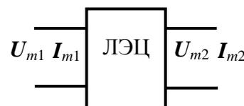
7. На рисунке показаны обозначения комплексных амплитуд токов и напряжений на входе и выходе четырехполюсной линейной электрической цепи. Такая цепь описывается двумя видами комплексных функций – входными и передаточными, которые имеют различный смысл и различные физические размерности: сопротивления, проводимости, безразмерные. Из вариантов ответов выберите тот, где указан правильный смысл комплексной функции.
