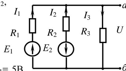
6. В цепи постоянного тока  $R_1=5$  Ом,  $R_2=5$  Ом,  $R_3=4$  Ом,  $E_1=5$ В,  $E_2=10$ В. Найти величины токов  $I_1, I_2, I_3$  и указать верную позицию ответа. В вариантах ответов величины токов в амперах указаны в той же последовательности. Знаки токов указывают их реальное направление в ветви.
