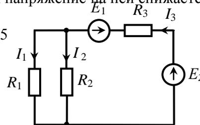
5. На рисунке изображена цепь постоянного тока. Величина э.д.с.  $E_1$  равна 2 В. Источники имеют нулевое внутреннее сопротивление. Величины сопротивлений  $R_1 = 200$  Ом,  $R_2 = 100$  Ом,  $R_3 = 50$  Ом. Определите величину эдс  $E_2$ , если ток через резистор  $R_1$  равен 20 мА.
