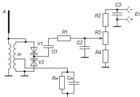
2. Найдите и исправьте две ошибки в схеме преселектора. Определите полосу пропускания преселектора по уровню  $d = 0,7$ , если: частота настройки входной цепи (ВЦ)  $f_0 = 80 \text{ МГц}$ ; избирательность по зеркальному каналу  $\sigma_z = 20 \text{ дБ}$ ; промежуточная частота супергетеродина  $f_{np} = 10 \text{ МГц}$ ;  $f_c > f_0$ .
