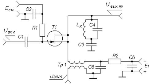
4. Найдите и исправьте две ошибки в схеме линейного последовательного амплитудного детектора (АД). Определите частоту модуляции источника ЭДС ( $E$ ), при которой искажения из-за инерционности нагрузки детектора ( $R1, C3$ ) и из-за разделительной цепи ( $C4, R2$ ) возникают при одном и том же коэффициенте модуляции сигнала, если:  $R1 = 10кОм$ ;  $R2 = 40кОм$ ;  $C3 = 500нФ$ .
