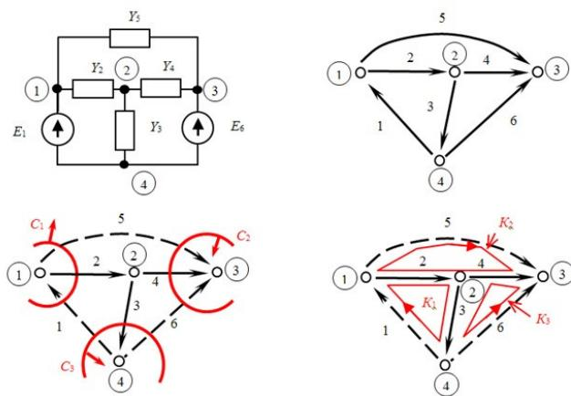
На рисунке показана электрическая схема цепи и ее направленный граф, на котором выделены главные сечения и контура. Записать матрицу главных сечений схемы.
