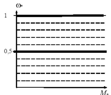
8. Какому способу регулирования соответствует искусственная механическая характеристика двигателя постоянного тока, изображенная на рисунке?
