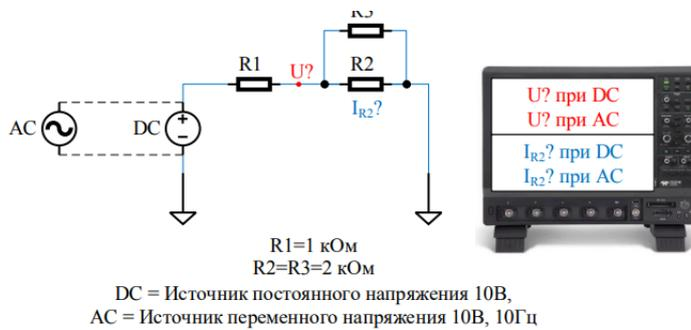
4. Выполнить расчет элементов и узлов электрической цепи
