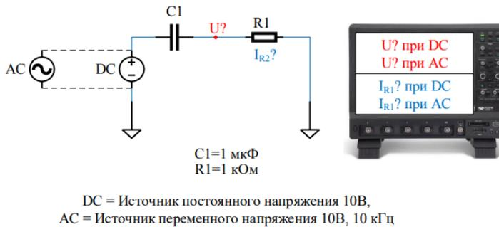
5. Выполнить расчет элементов и узлов электрической цепи
