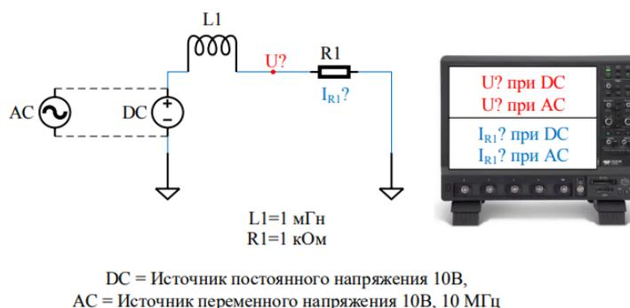
3. Выполнить расчет элементов и узлов электрической цепи
