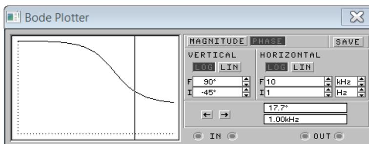
Пример измерения фазового сдвига (равен  $17,7^\circ$  на частоте 1 кГц)
