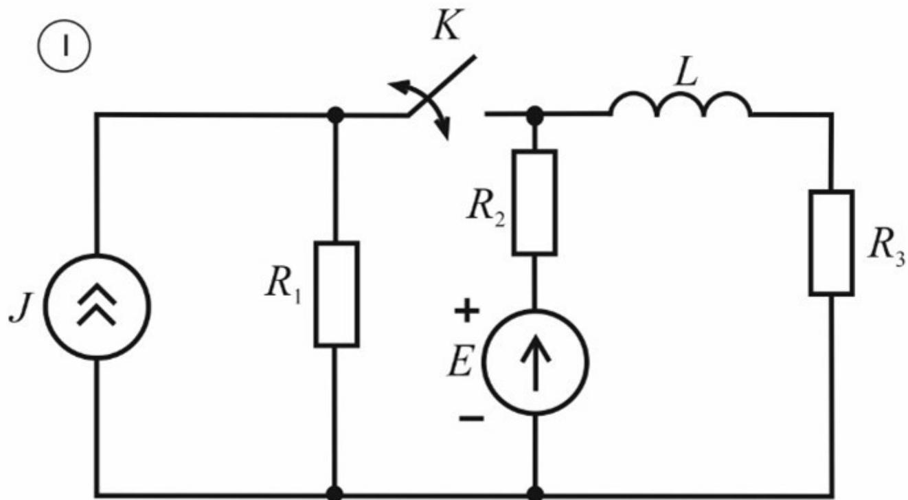
1.  $E = 5 \text{ В}$ ;  $I = 1 \text{ А}$ ;  $L = 0,001 \text{ Гн}$ ;  $R_1 = 1000 \text{ Ом}$ ;  $R_2 = 240 \text{ Ом}$ ;  $R_3 = 1000 \text{ Ом}$ ;  $t_0 = 100 \text{ мкс}$ .
