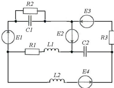
4. Рассчитать переходный процесс на индуктивности любым удобным методом для схемы на рисунке. Определить через какое время в цепи будет наблюдаться установившийся режим, если  $R=250$  Ом,  $L=20$  мГн.
