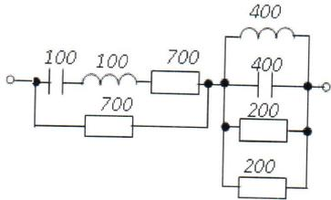
7. На некоторой частоте  $\omega$  сопротивления отдельных участков цепи заданы в Омах. Рассчитайте сопротивление на указанной частоте. Как изменится входное сопротивление участка цепи, если частота входного воздействия увеличится в 2 раза?
