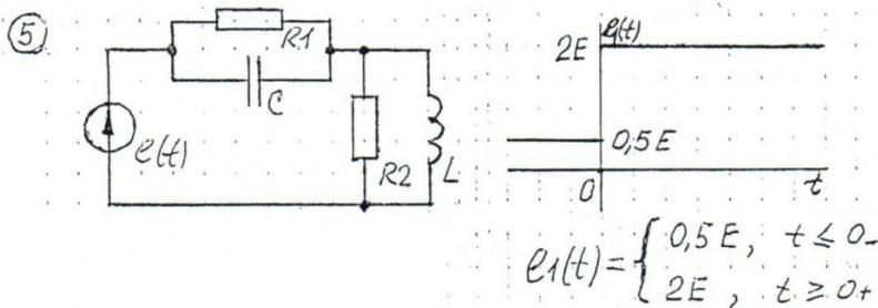
4. Индивидуальное задание "Расчет переходных процессов в линейных электрических цепях": Вариант задания определяется шифром; первая цифра - номер строки в табл. 1, вторая цифра – номер строки в табл. 2, последняя – номер исследуемой цепи. Требуется выполнить:
