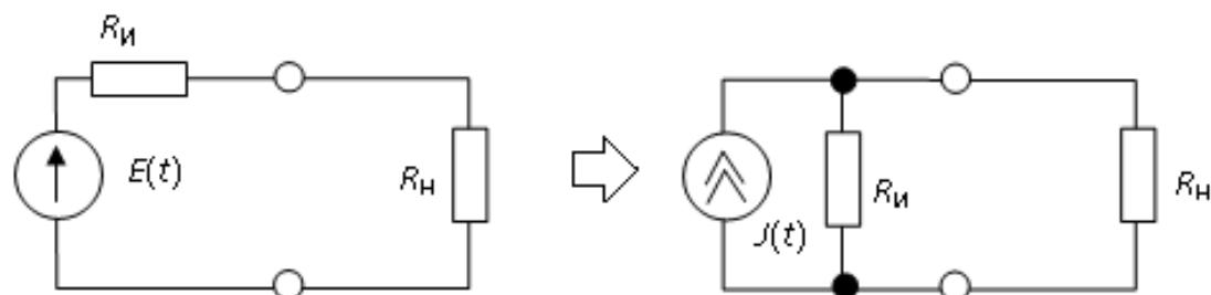
Преобразуйте неидеальный источник напряжения  $E(t) = 10$  В,  $R_h = 50$  Ом,  $R_i = 1$  кОм в эквивалентный ему источник тока  $J(t)$ . Величину источника тока указать в мА. Ответ при необходимости округлить до целого числа.
