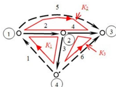
На рисунке показана электрическая схема цепи и ее направленный граф, на котором выделены главные сечения и контура. Записать матрицу главных сечений схемы (выберите верную матрицу)
