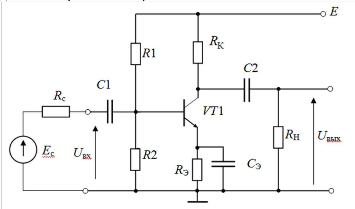
17. Для чего используется делитель напряжения  $R_1-R_2$  в схеме УНЧ?
