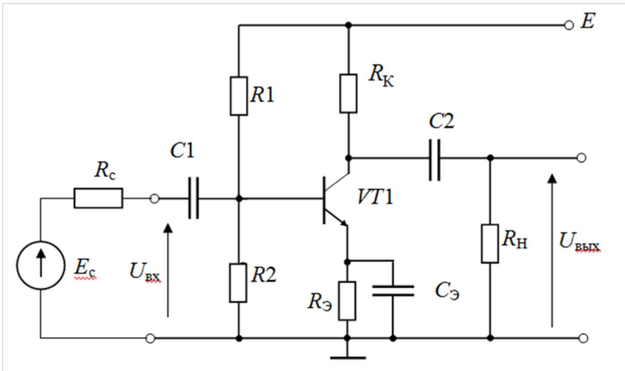
17. Для чего используется делитель напряжения  $R_1-R_2$  в схеме УНЧ?
