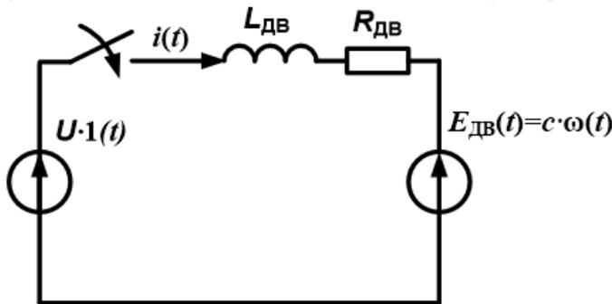
1.  $U \cdot 1(t) = R_{дв} \cdot i(t) + L_{дв} \cdot \frac{di(t)}{dt} + E_{дв}(t) ;$
