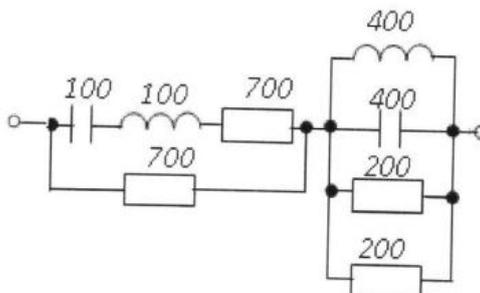
5. На некоторой частоте  $\omega$  сопротивления отдельных участков цепи заданы в Омах. Рассчитайте сопротивление на указанной частоте. Как изменится входное сопротивление участка цепи, если частота входного воздействия увеличится в 2 раза?
