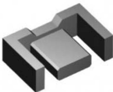
Дан электромагнитный элемент броневое типа, выполненный на сердечнике типоразмера EFD, центральный стержень которого имеет форму овала с размерами полуосей  $a$  и  $b$ .
